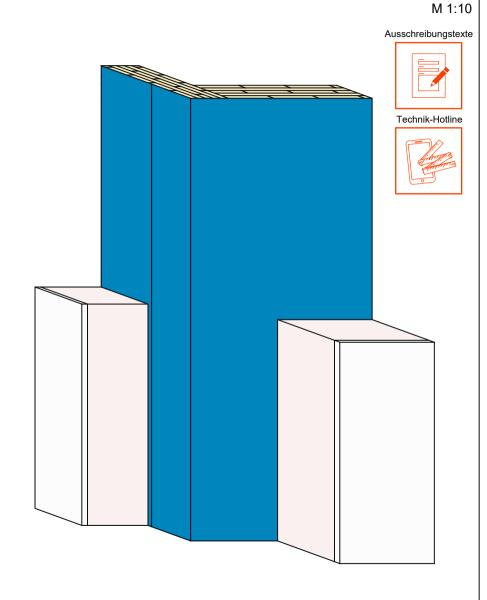
Holzmassivbau Außenecke Luftdichtung mit SOLITEX ADHERO
