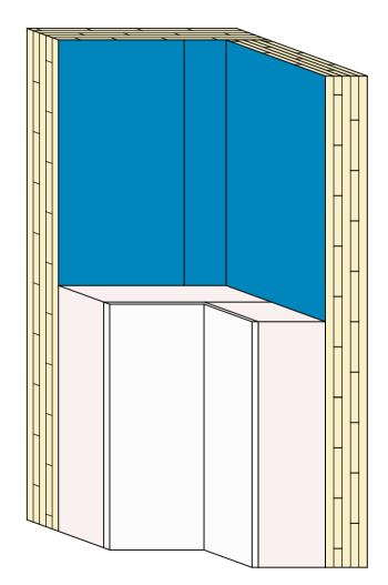
Holzmassivbau Innenecke Luftdichtung mit SOLITEX ADHERO Var. 2
