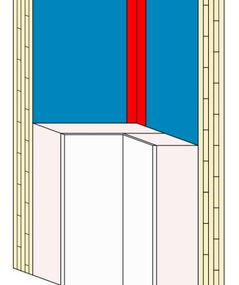
Holzmassivbau Innenecke Luftdichtung mit SOLITEX ADHERO Var. 1
