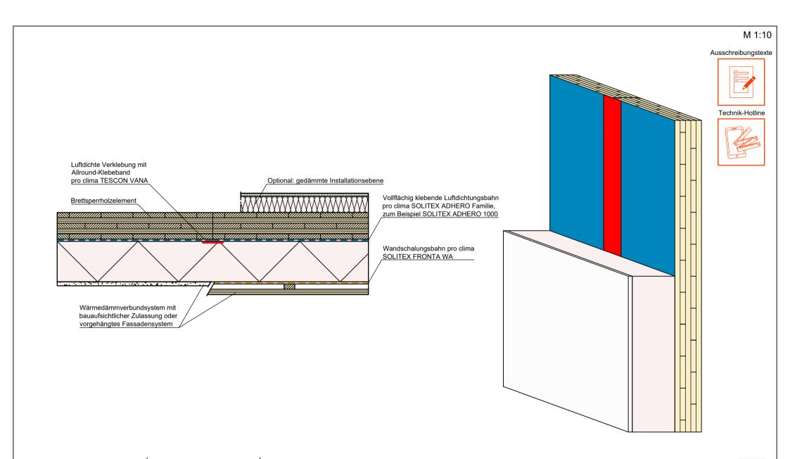
Holzmassivbau Elementstoß Luftdichtung mit SOLITEX ADHERO Var. 1
