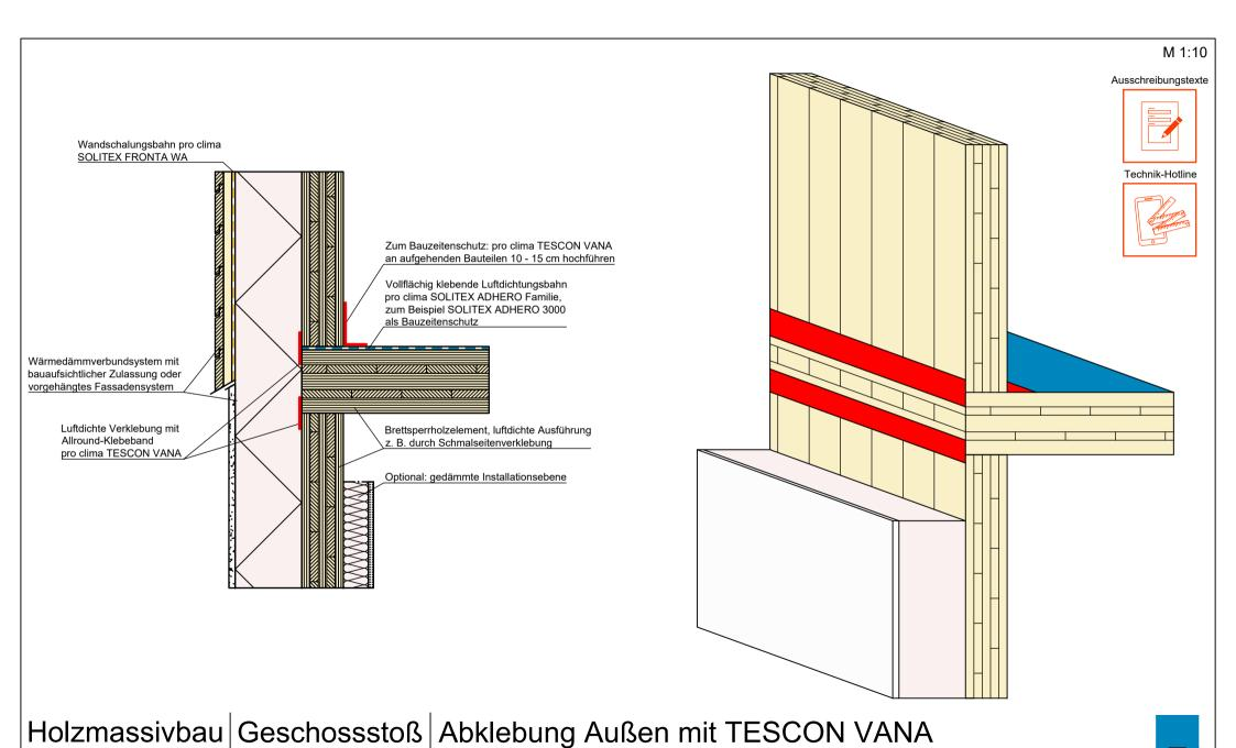
Luftdichte Abklebung auf der Außenseite mittels pro clima TESCON VANA. Brettsperrholzelemente müssen luftdicht hergestellt sein.
