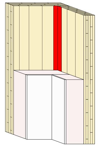
Holzmassivbau Innenecke Abklebung Außen mit TESCON PROFECT
