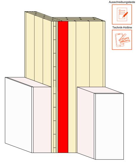
Holzmassivbau Außenecke Abklebung Außen mit TESCON VANA
