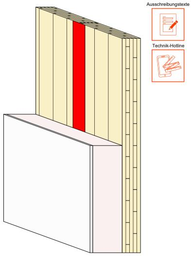
Holzmassivbau Elementstoß Abklebung Außen mit TESCON VANA
