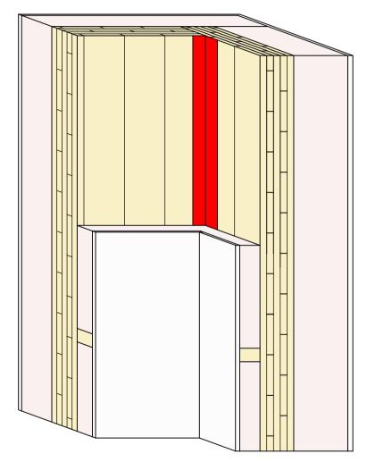
Holzmassivbau Außenecke Abklebung Innen mit TESCON PROFECT
