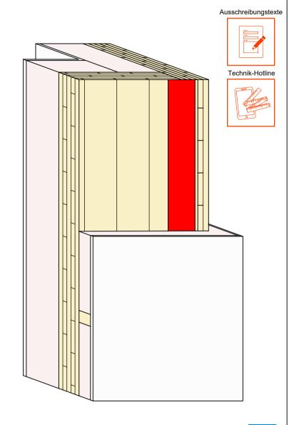
Holzmassivbau Innenecke Abklebung Innen mit TESCON VANA
