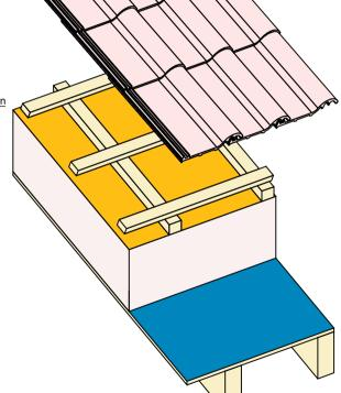
Dachsanierung von außen Steildach Regelaufbau, Aufdachdämmung
